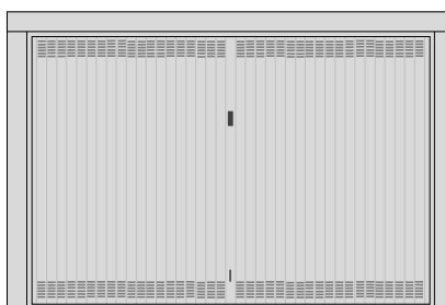
Feritoie o asole o microforo sopra e sotto
