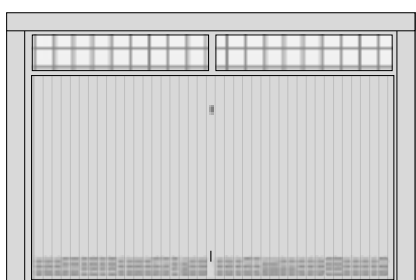
Parte a rete superiore e feritoie o asole inferiori
